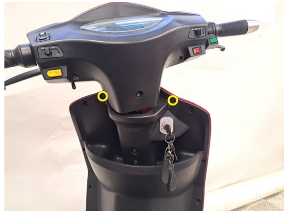
Irrota etupaneelin kiinnitysruuvit. (ristipäämeisseli ph2).
